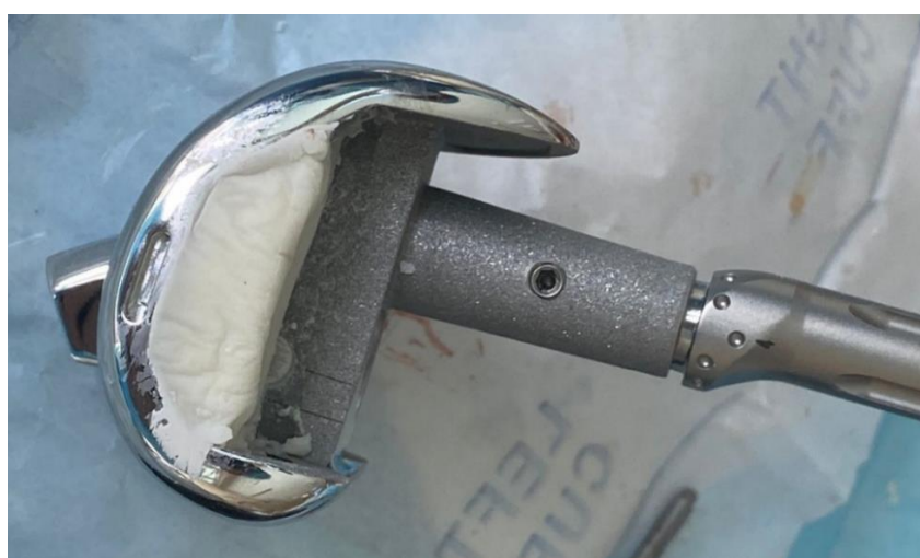
Рисунок 44 – Разработанный эндопротез с костным аугментом, нанесенным по маркировочной линии
